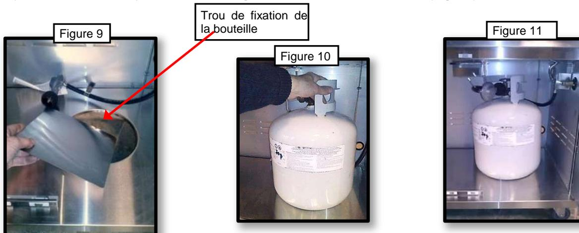
18. Ouvrez le robinet de la bouteille LENTEMENT (dans le sens contraire des aiguilles d'une montre) jusqu'à ce qu'il soit complètement ouvert. Avant d'allumer le barbecue, vérifiez l'étanchéité de tous les raccords avec une solution d'eau savonneuse (test de détection des fuites). Si une fuite est détectée, n'utilisez PAS le barbecue. Fermez le gaz et appelez un installateur de gaz professionnel pour réparer la fuite.
